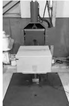
Fig.11 Free fall test
