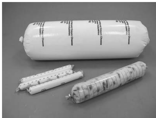
写真4 ロケット包装された製品 (奥: クリームチーズ、手前左: スティックプロセスチーズ、手前右: レーズンバター)
