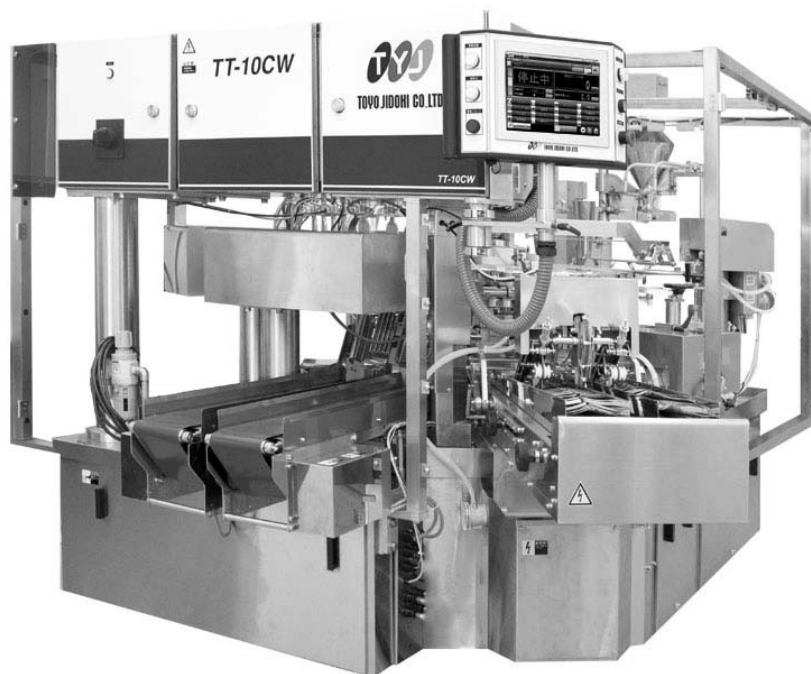
図1 スタンディングパウチ用充填機(東洋自動機株製)
