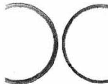
写真2 右側が軽量びんの断面
