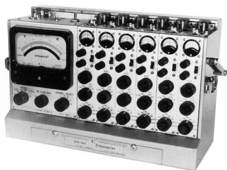
図6 当時使用した動ひずみ計
