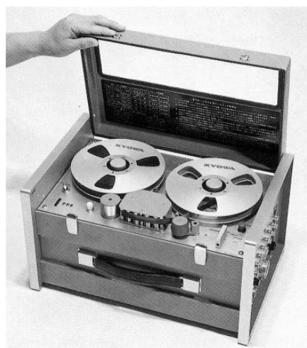
図7 オープンリールタイプの 車載用データレコーダ
