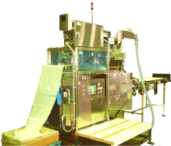
図5 全自動式無菌充填機の例
