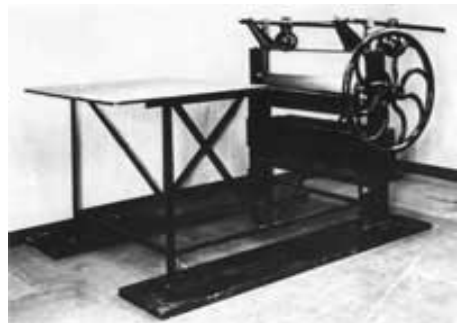
写真2 段ボール製造1号機(復元機)
